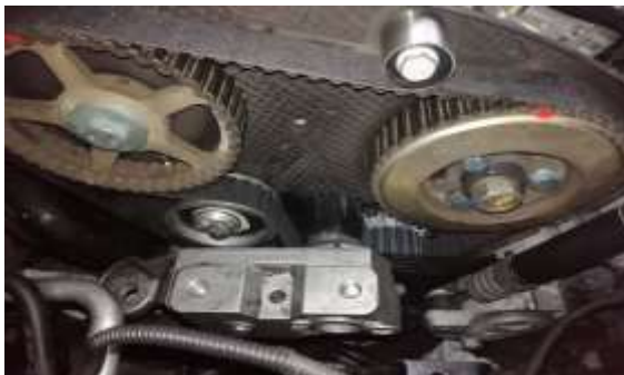
Slika 9-postavljeni novi zupčasti remen.
