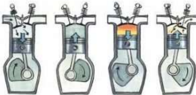
SLIKA 9:Rad četverotaknog motora. 1 usis,2 kompresija, 3 ekspanzija, 4 ispuh
